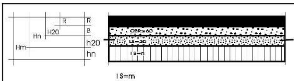
De acordo com os parâmetros, seguimos com as fórmulas para obtenção das espessuras dos pavimentos:
